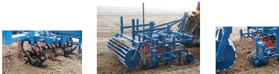
Les disques étoiles travaillent le sol, ils sont situés au centre de l'outil, les disques forment la butte
