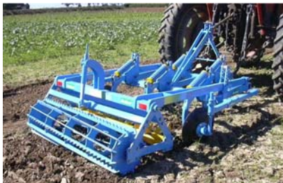
Reprise du sol : Bio 2000 (griffon proche de l'actisol)
