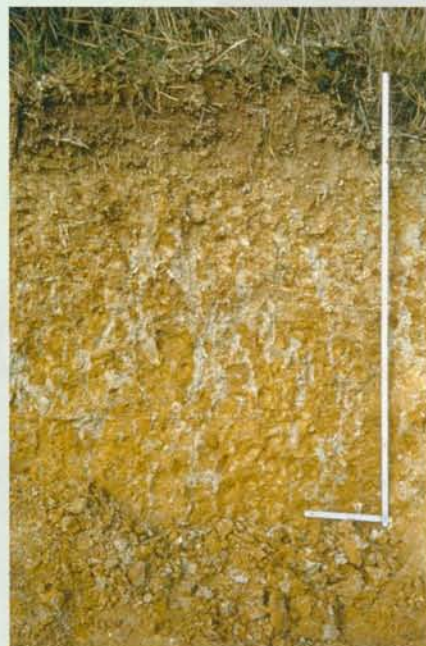
Profil de sol : sol lessivé à engorgement superficiel temporaire sur limon de plateau humide
